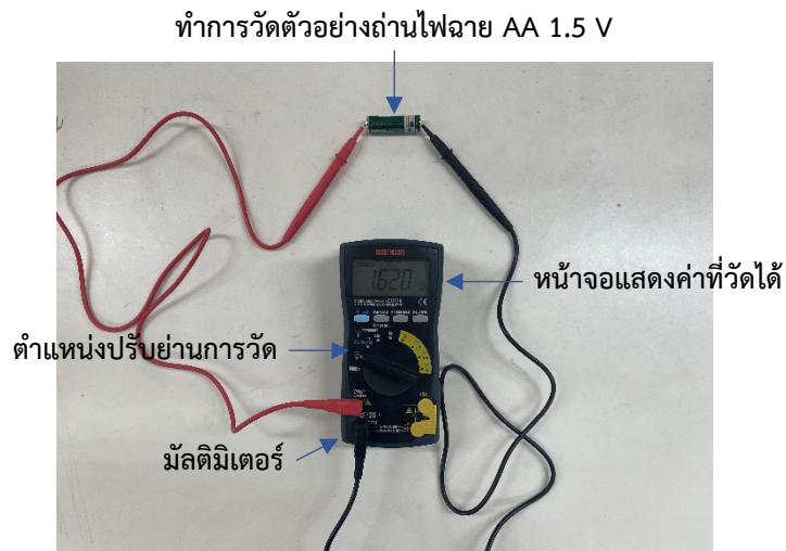
รูปที่ 3.6 ทดสอบการตั้งย่านการวัดของเครื่องมัลติมิเตอร์ เพื่อวัดความต่างศักย์ก่อนการใช้งาน
