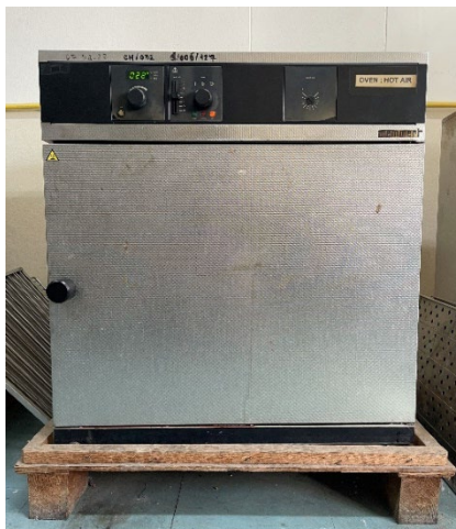
รูปที่ 3.10 ตู้อบลมร้อน (Hot air oven) ยี่ห้อ MEMMERT รุ่น ULE500
