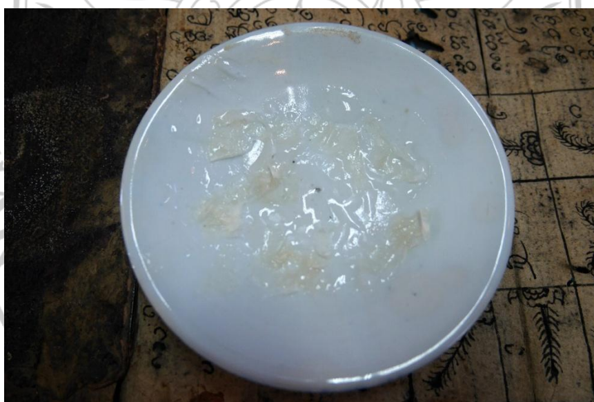
ภาพที่ 4.21 ลักษณะกระดาศขึ้นเล็ก ๆ ในแผ่นกระเบื้องที่มีกาวเมทิลเซลลูโลส
