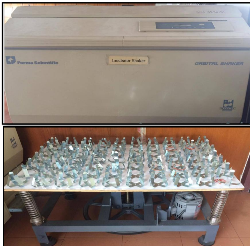
รูปที่ 4.27 เครื่องเขย่า (Shaker) สำหรับเลี้ยงเนื้อเยื่อพืชในสภาพอาหารเหลว
