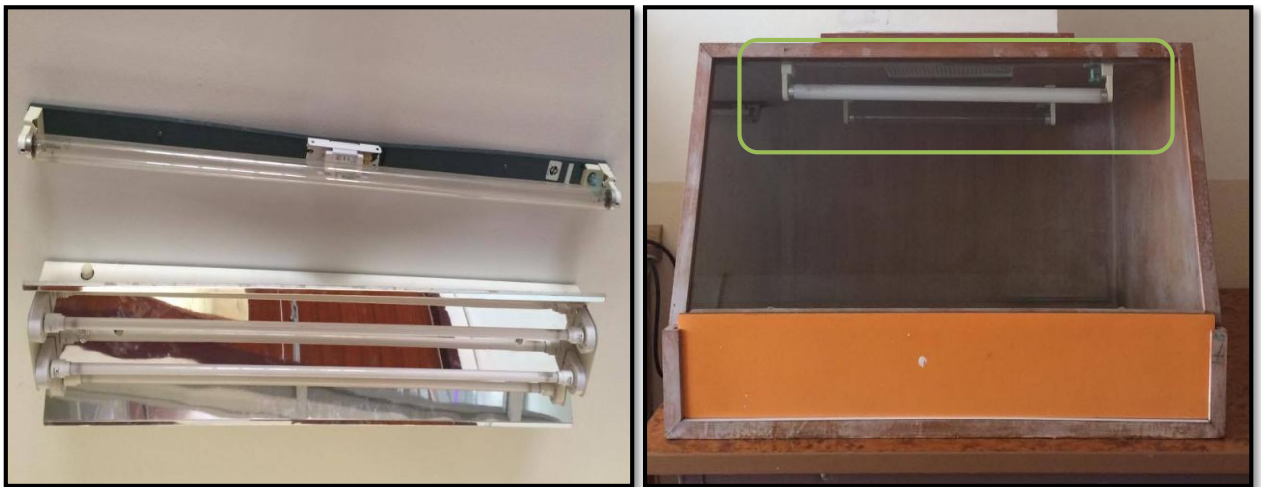
รูปที่ 4.22 หลอดยูวี (UV lamp) ติดคู่กับหลอดฟลูออเรสเซนต์ (Fluorescence lamp) ทั้งในห้องและในตู้เชื้อ
