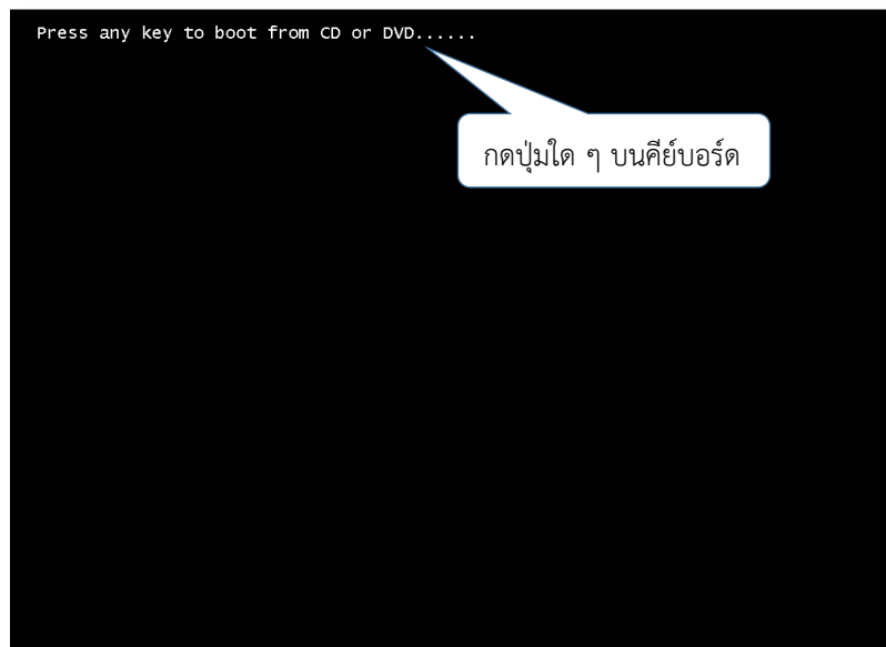
ภาพที่ 4.4 แสดงการเริ่มการติดตั้ง Microsoft Windows 2022 Server
